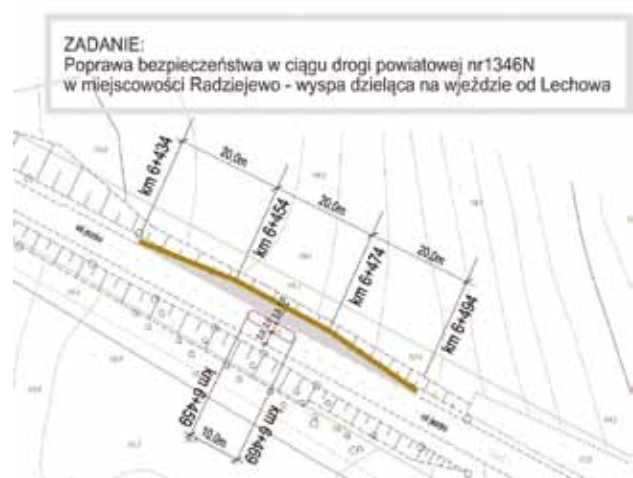
Droga powiatowa w Radziejewie, budowa wyspy przy wjeździe
